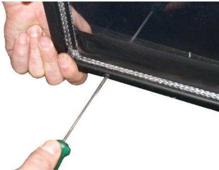
Fig. 55 - Lösen der Schrauben
