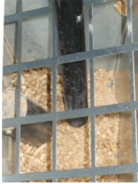
Fig. 47 - Reinigung Tank und Schnecke
