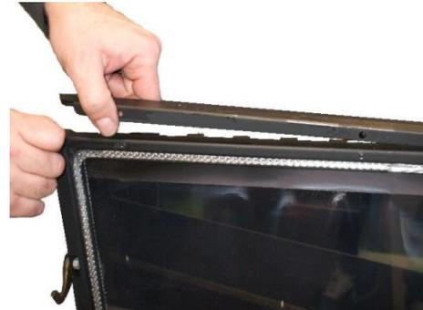
Fig. 56 - Entfernen der Türprofile
