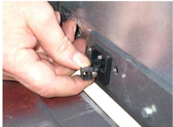
**Fig. 64 - Austausch der Sicherung**
