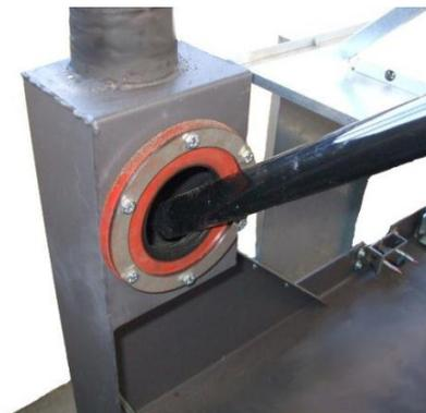
Fig. 49 - Reinigung des Rauchgaskanals
