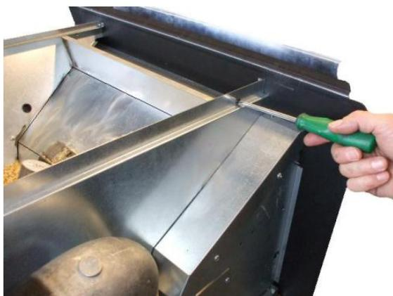
Fig. 59 - Die Schrauben zur Befestigung des Gehäuses lösen.
