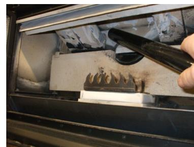
**Fig. 46 - Reinigung des oberen Teils**
