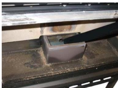
**Fig. 44 - Reinigung Fach Brennschale**
