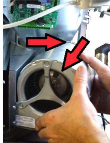
**Fig. 62 - Ausbau des Gebläses**
