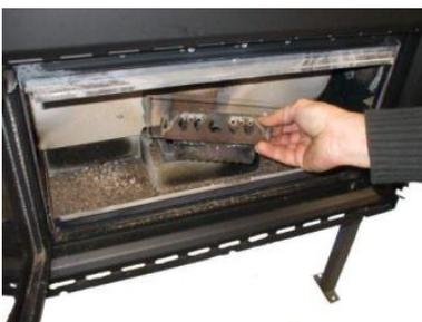
Fig. 39 - Brennschale entnehmen
