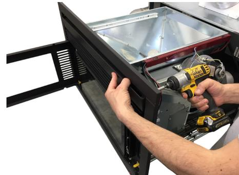
**Fig. 37 - Fixieren Frontplatte**
