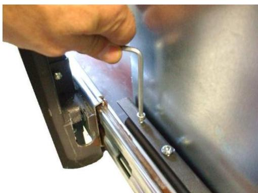
Fig. 20 - Hintere Befestigungsschraube des Einsatzes
