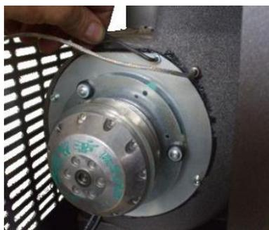
**Fig. 50 - Reinigung Rauchgasansauggerät: Phase 1**
