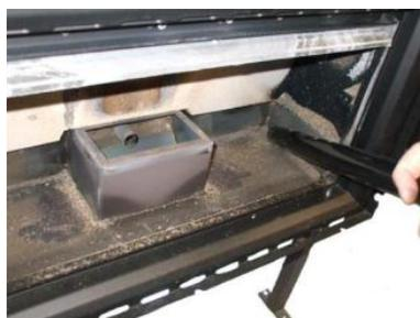
**Fig. 45 - Reinigung Fach Aschenkasten**
