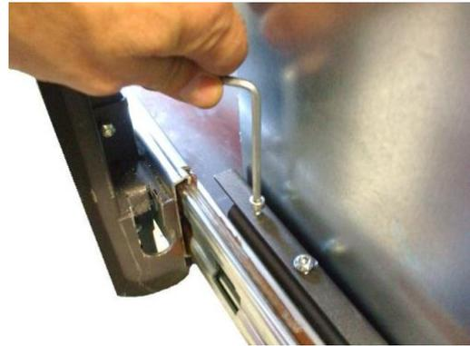
Fig. 15 - Hintere Befestigungsschraube des Einsatzes
